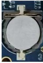
后备电池用于保证断电后 RTC 仍然能够工作，确保系统时间不丢失。ibox3568 自带有外置 RTC 芯片，工作电流低于 0.6uA 以下。
