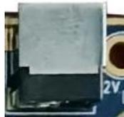
ibox3568 采用 12V 直流电源供电，图中插座为 12V 直流电源输入插座。
