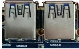
RK3568 自带两路 HOST3.0 接口，开发板通过两个 HOST3.0 座子引出。注意左侧的 HOST3.0 接口，其 HOST2.0 功能和 OTG 接口复用，只有当 OTG 右侧的拨码开关拨到上侧时，HOST3.0 接口对应 HOST2.0 功能才是完整的。
