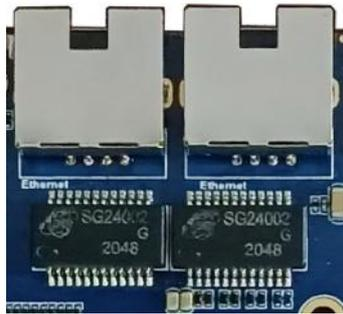
ibox3568 支持两路千兆有线以太网接口，以太网芯片采用国产裕太微电子的 YT8521CA，用户可以通过有线以太网上网，体验极速网络。
