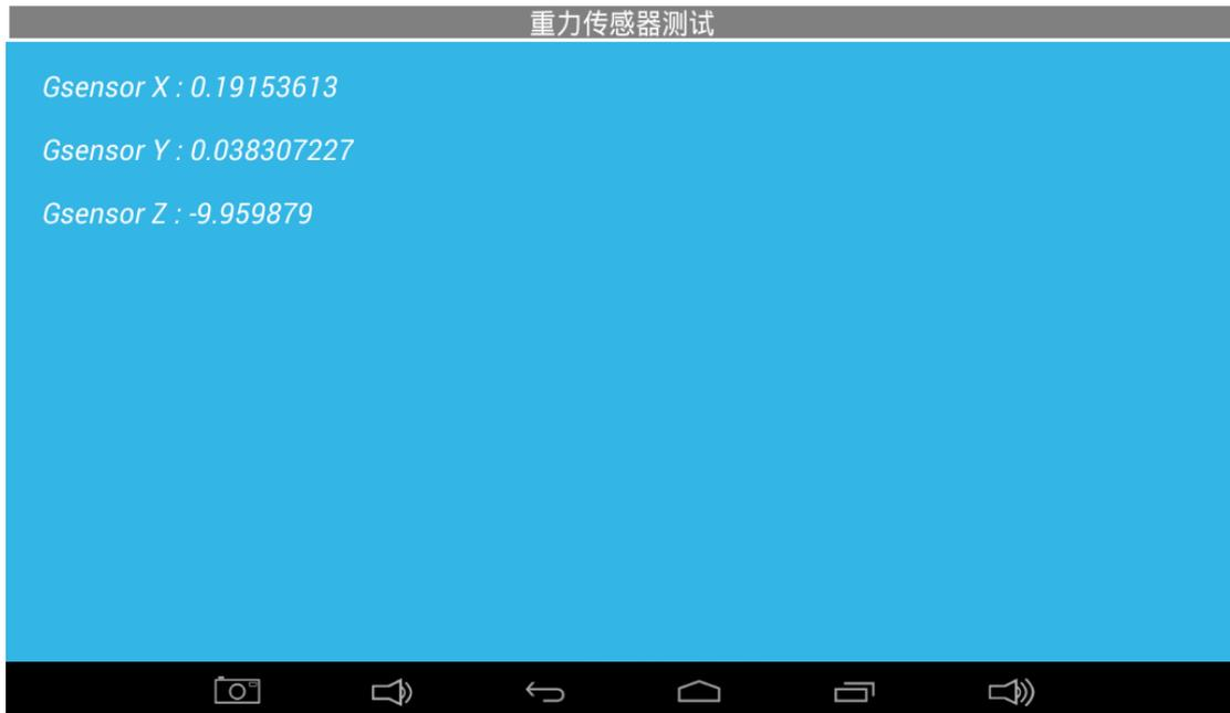
旋转开发板时，上面的 X，Y，Z 轴的值会随之发生变化。
