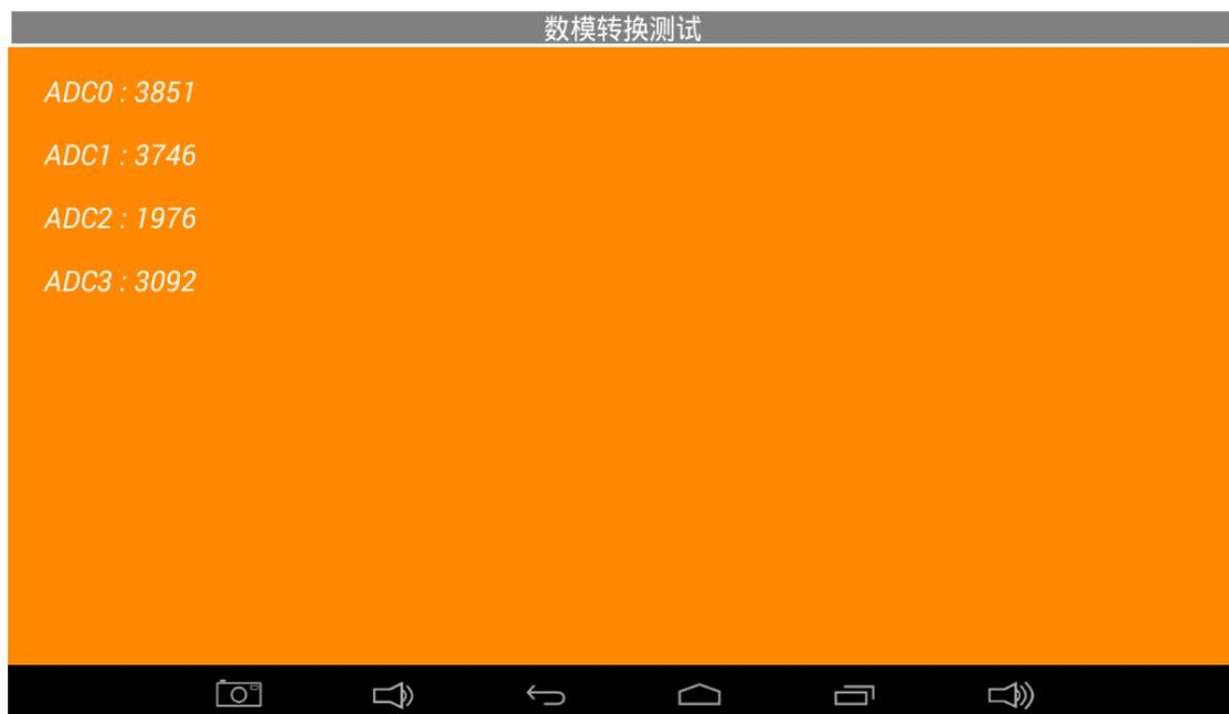
监测四路 ADC 的电压。我们可以通过调节开发板上的精密可调电位器，观察上面对应通道的电压是否变化。
