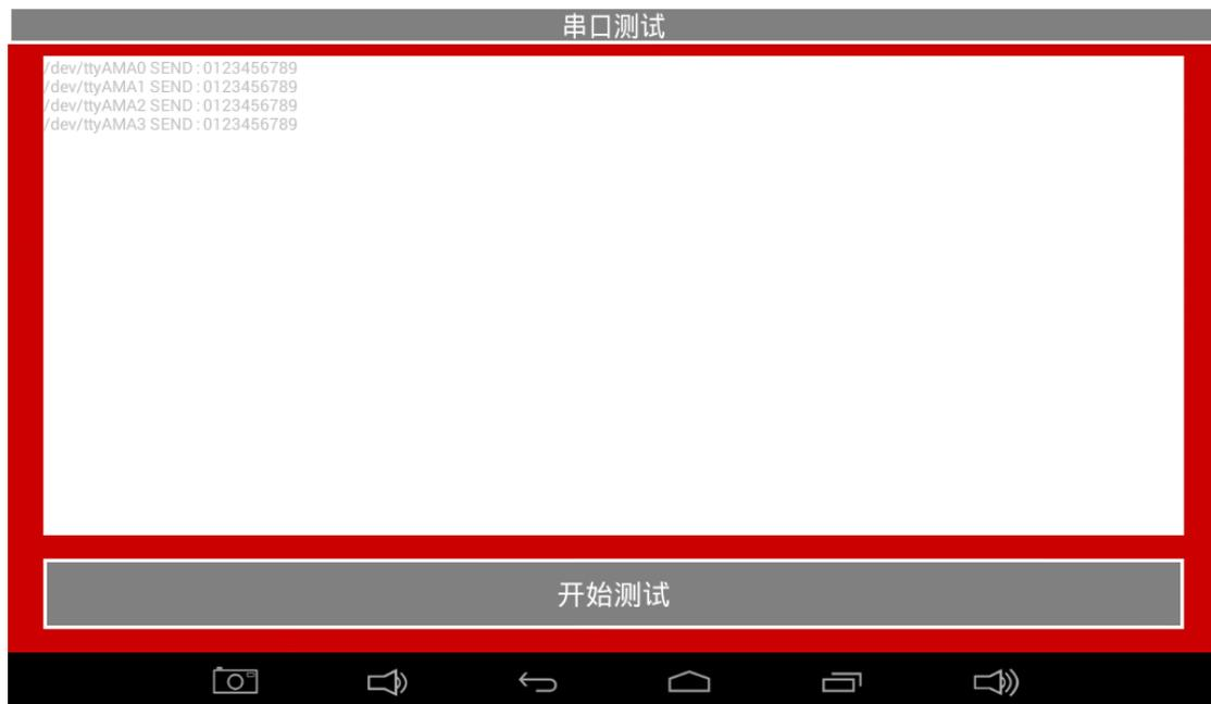
将需要测试的串口的 TXD 和 RXD 短路，再点击开始测试，界面上会提示对应串口会自发自收 0123456789。如果不能自发自收，说明对应的串口硬件有问题。
