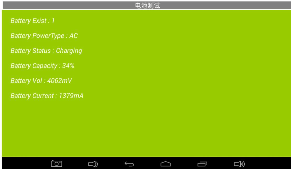
该界面反应了接在开发板上的电池电量信息。
