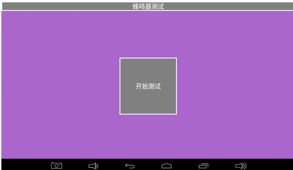
按住开始测试键，蜂鸣器会鸣叫，松开开始测试键，蜂鸣器停止鸣叫。
